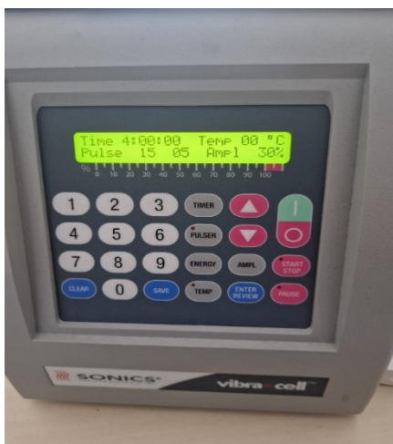
Figura 2.1. Parametri de lucru pentru dispersarea nanofibrelor de celuloză și a nanomaterialelor grafenice.
