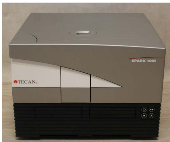
Figura 1.9. Fluorimetru - aparatul de măsurare al procesului optic de fluorescență (TECAN-SPARK).
