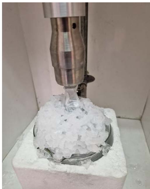
Figura 1.5. Dispersarea grafeinei aminate în amestecul de polimeri prin ultrasonare.
