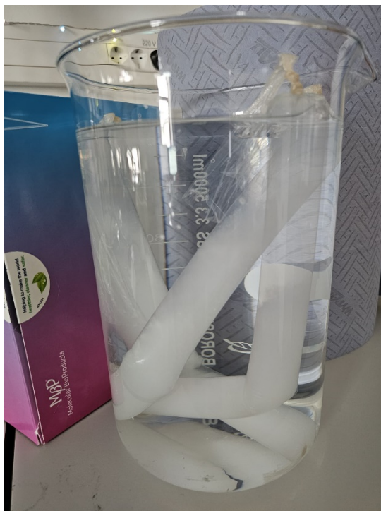
Figura 1. Dializa soluției de gellan metacrilat utilizând membrane de 14 kDa în apă distilată
