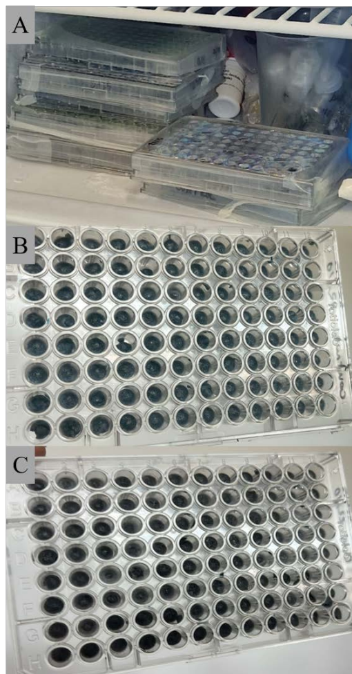
Figura 4. Înghețarea probelor și aspectul acestora după procesul de liofilizare.
