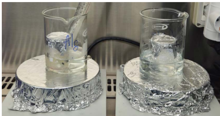
Figura 4. Sinteza formulărilor pe bază de alginat, K-caragenan și spirulină în condiții sterile pentru bioprintare 3D.
